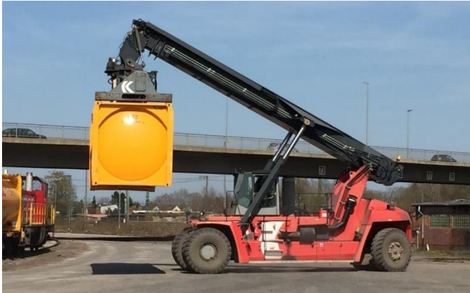
Bild: Verladung eines Containers mittels Reachstacker
